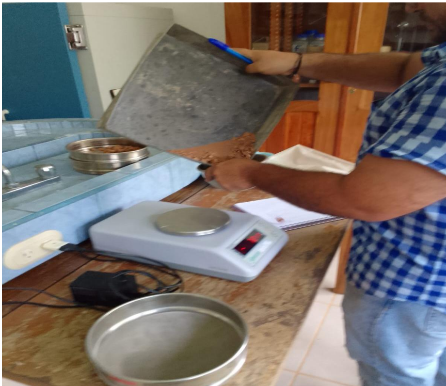
Ilustración 18 Proceso de Pesado de las Muestras en Laboratorio URACCAN
