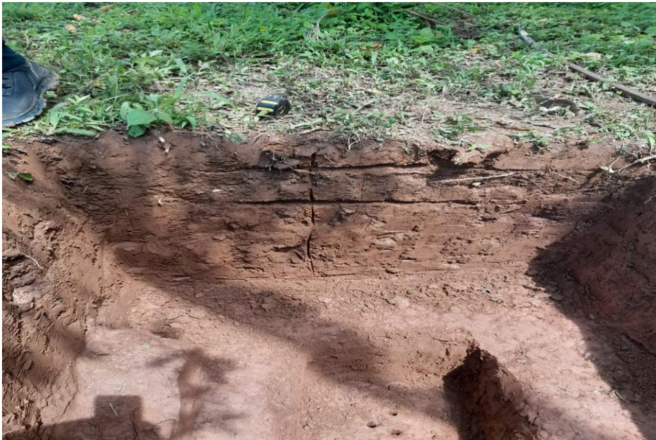
Ilustración 14 determinación de los horizontes o estratos de la calicata. Fuente propia
