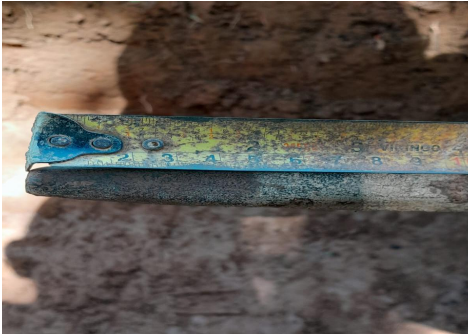
Ilustración 17 Medición de la profundidad del lanzamiento de la barra. Fuente propio.
