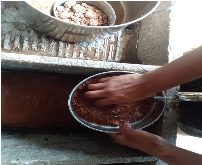
Ilustración 20 Lavado de la Muestra de Suelo para el Estudio Granulométrico
