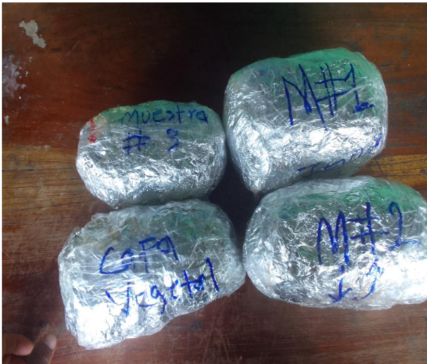
Ilustración 16 empaque y rotulado de las muestras de suelo
