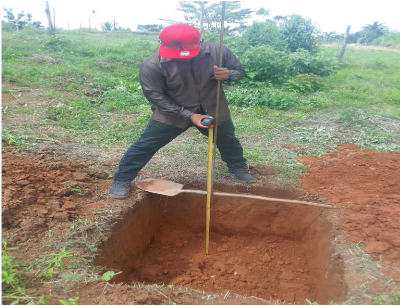
Ilustración 13 Lanzamiento de la barra para determinar la capacidad de carga portante del suelo. Fuente Propia.
