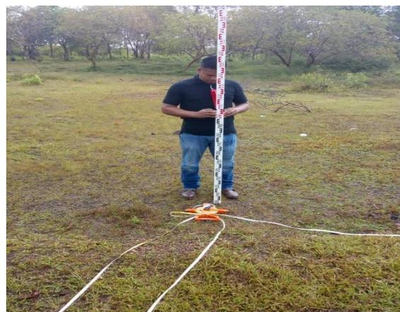
**Fig.# 39 levantando nivel del terreno.**
